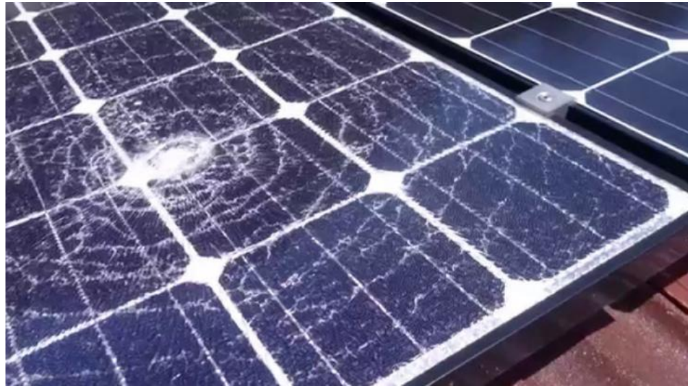
Figure 8 : panneaux ayant subi un impact (image wikimedia commons)
