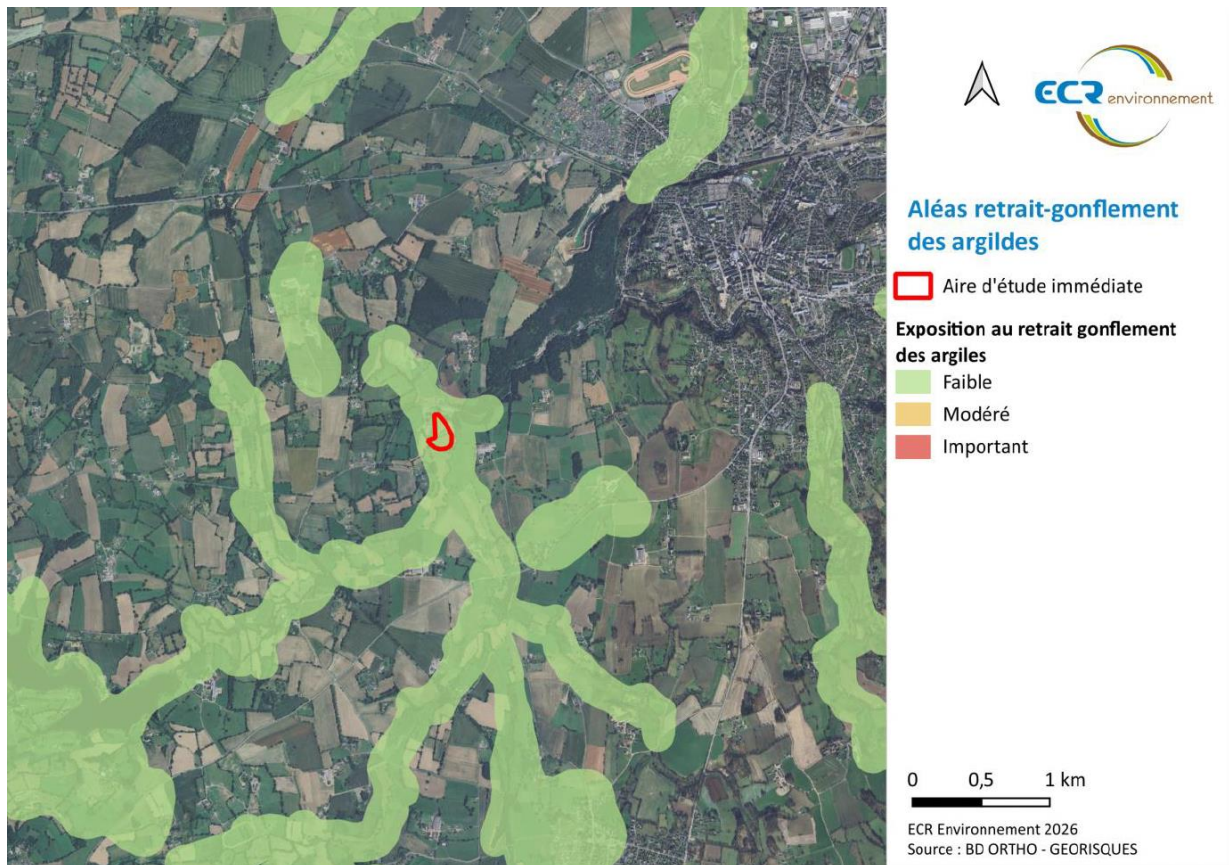
Aléas retrait-gonflement des argiles (Source : Géorisque)
