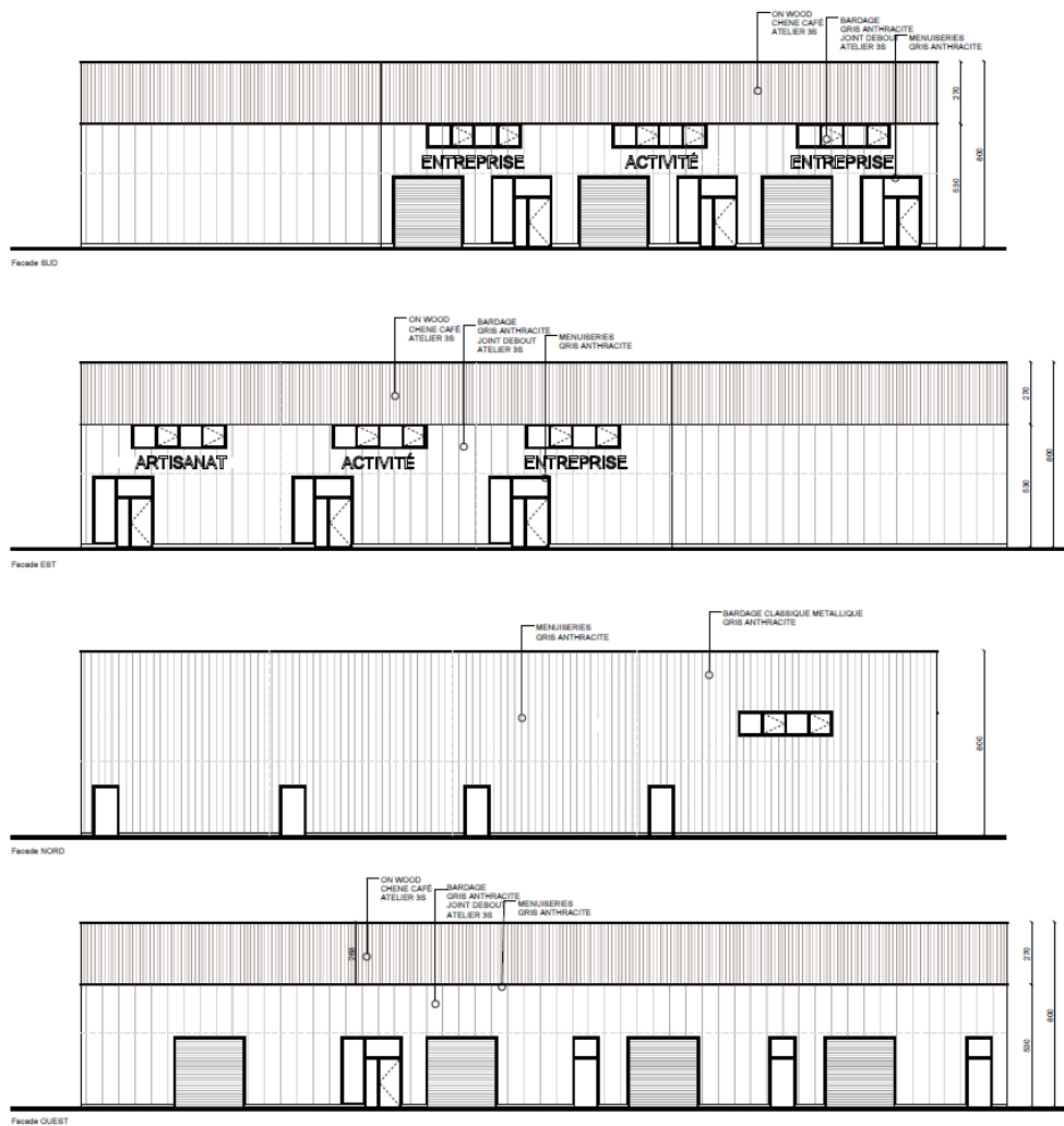
Figure 21 : Plan façade projet – Bâtiment n°2 – Bouchet Architecture
