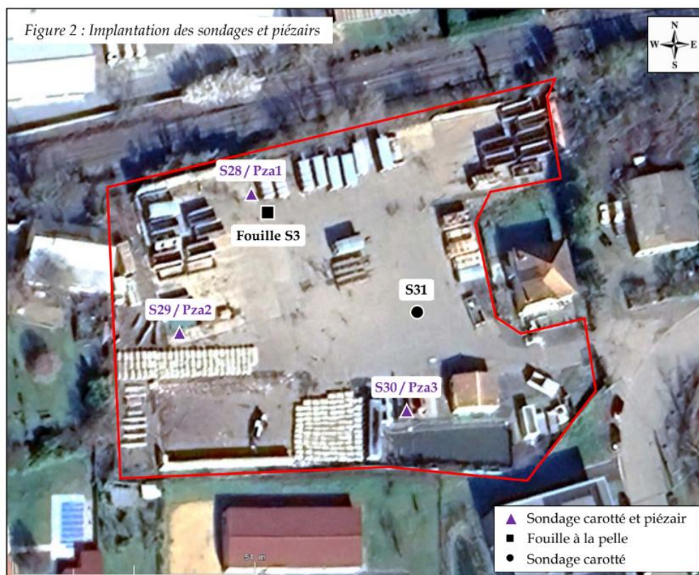
Figure 6 : Implantation des sondages et piézaires (source : Rapport Prélèvements et analyses de gaz du sol-Terrest)
