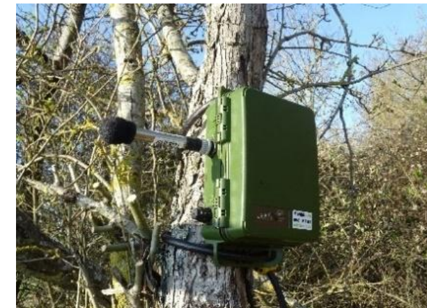
Photo 2 : Détecteur d'ultrasons utilisé lors de l'étude
