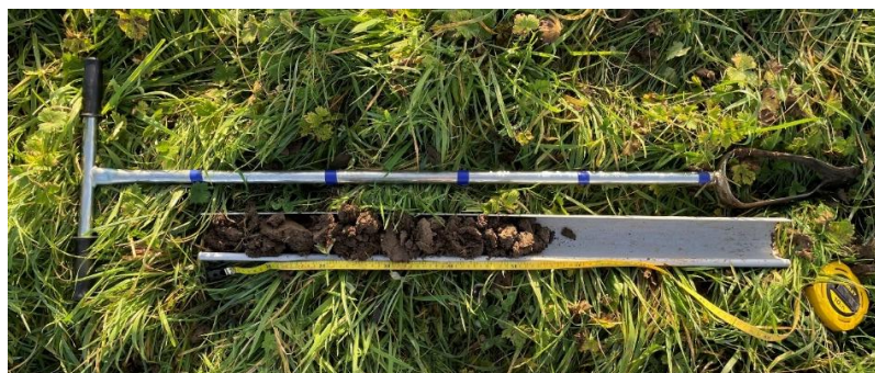
Figure 2 : Exemple d'un prélèvement pédologique disposé dans une gouttière en PVC
