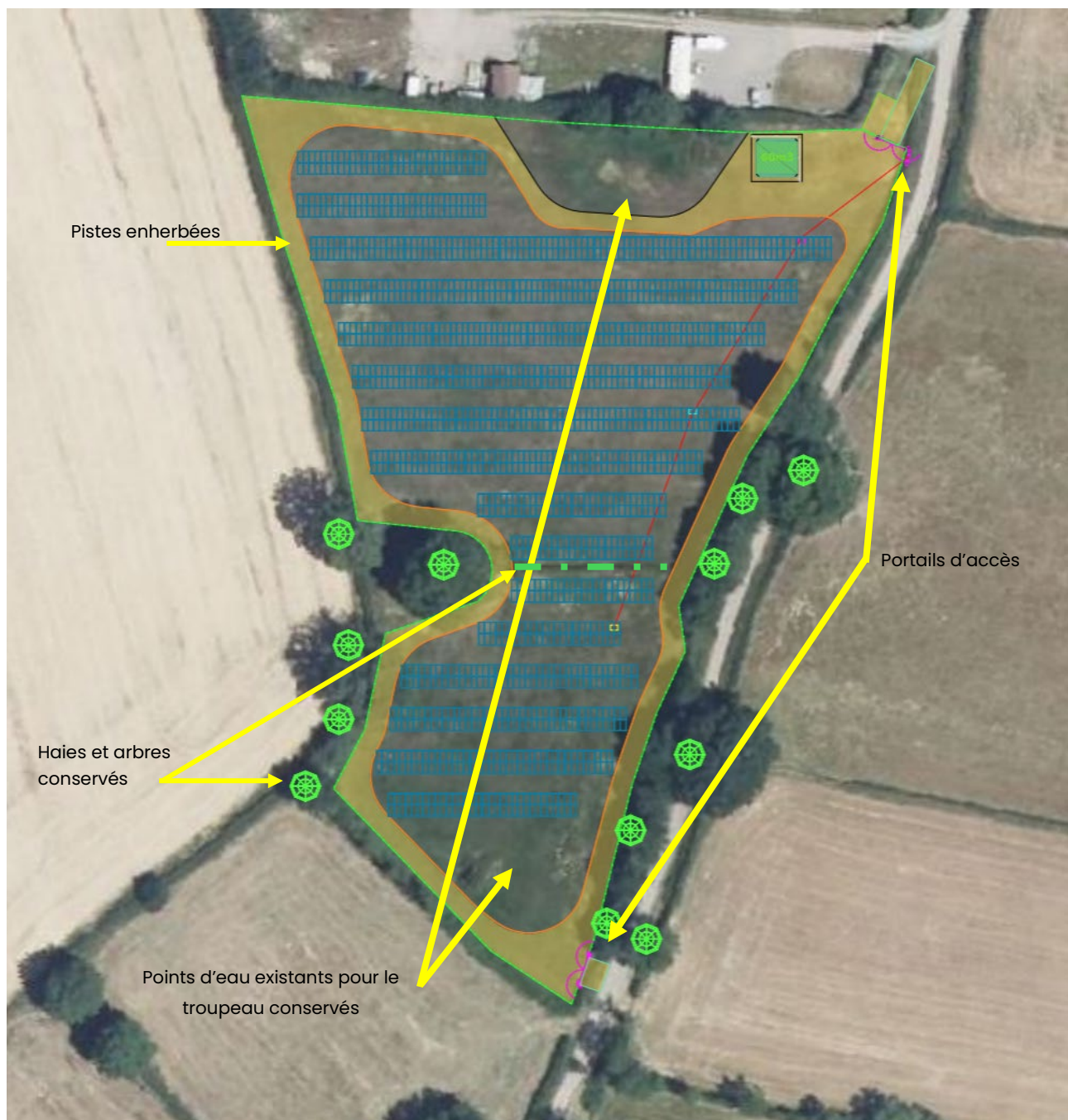
Figure 4 : Plan d'aménagement de la centrale photovoltaïque
