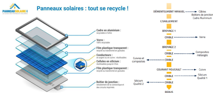
Figure 10 : Recyclage d'un panneau solaire (source : SOREN)
