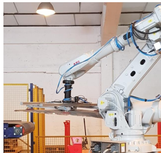
Figure 8 : Chargement du modules laminés avant découpage, broyage et séparation des éléments
