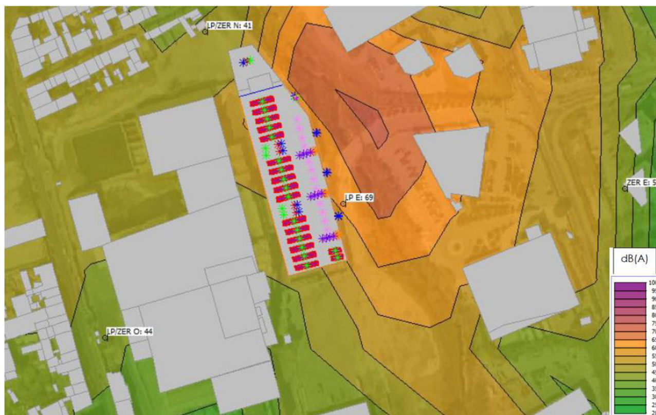
Figure 59 : Impact sonore futur évalué du projet – Mode maintenance du groupe électrogène
