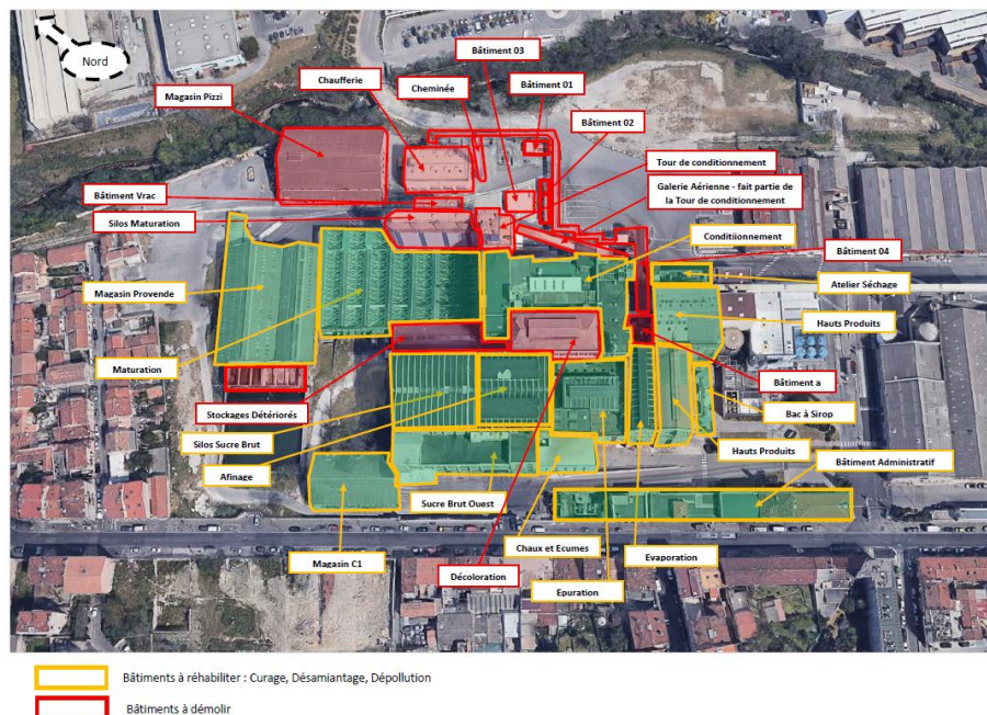
Figure 4 : Bâtiments à démolir et à réhabiliter
