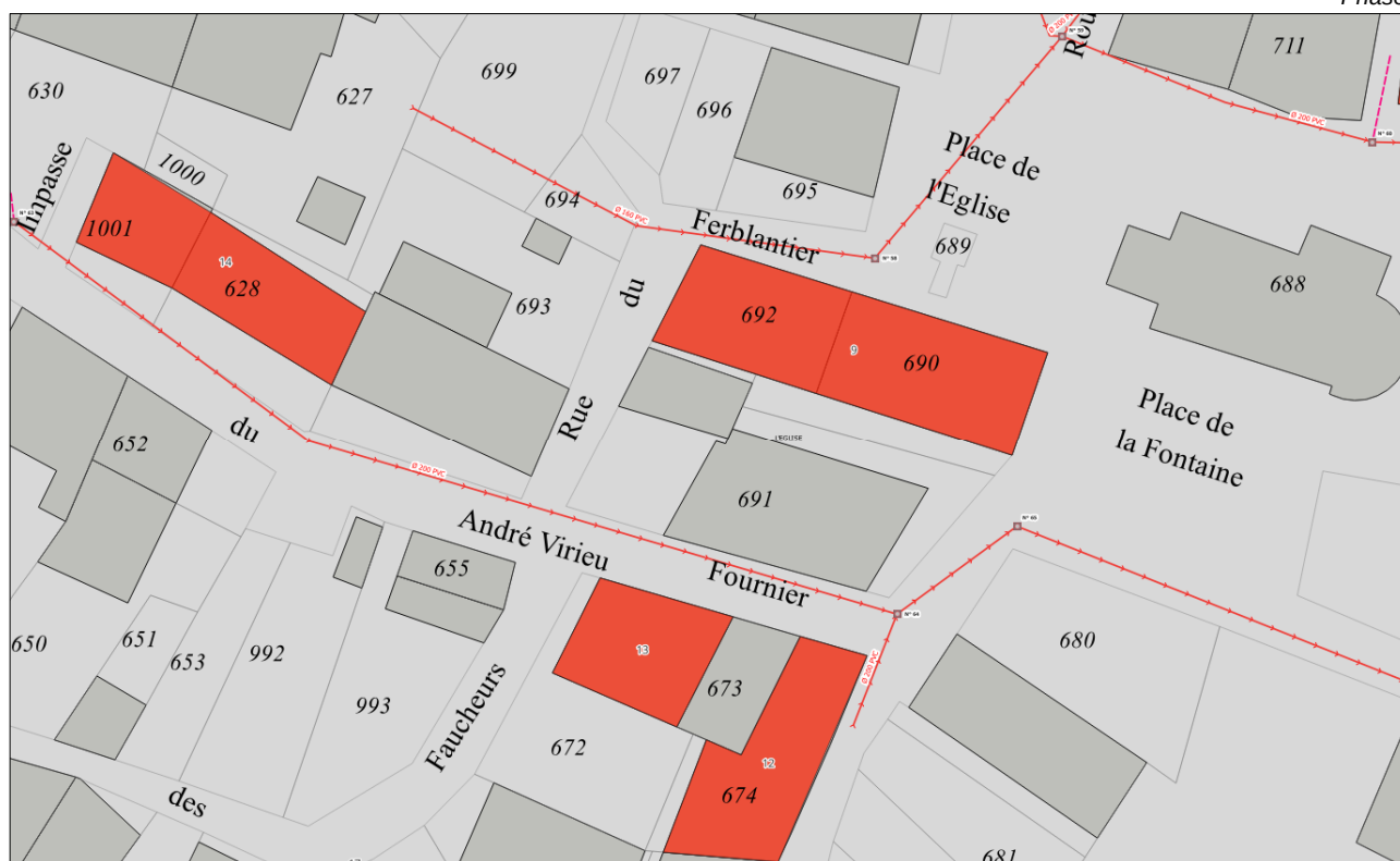
Figure 39: Extrait de plan du SDA illustrant les habitations avec un branchement non conforme. (Données du test à la fumée-A.T.EAU le 02/05/2009)
