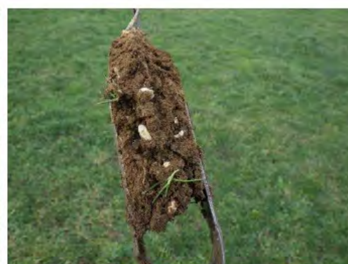
Photos 8 et 9 : Exemples des sols argilo-calcaires observés lors des sondages (1/2)
