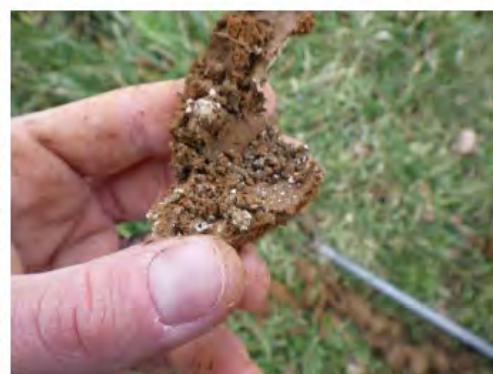
Photos 10 et 11 : Exemples des sols argilo-calcaires observés lors des sondages (2/2)
