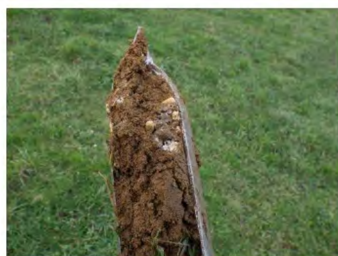
Photos 8 et 9 : Exemples des sols argilo-calcaires observés lors des sondages (1/2)
