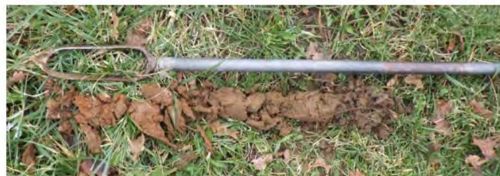
Photo 6 : Exemple de sondage pédologique réalisé sur 70cm
