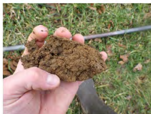
Photos 10 et 11 : Exemples des sols argilo-calcaires observés lors des sondages (2/2)
