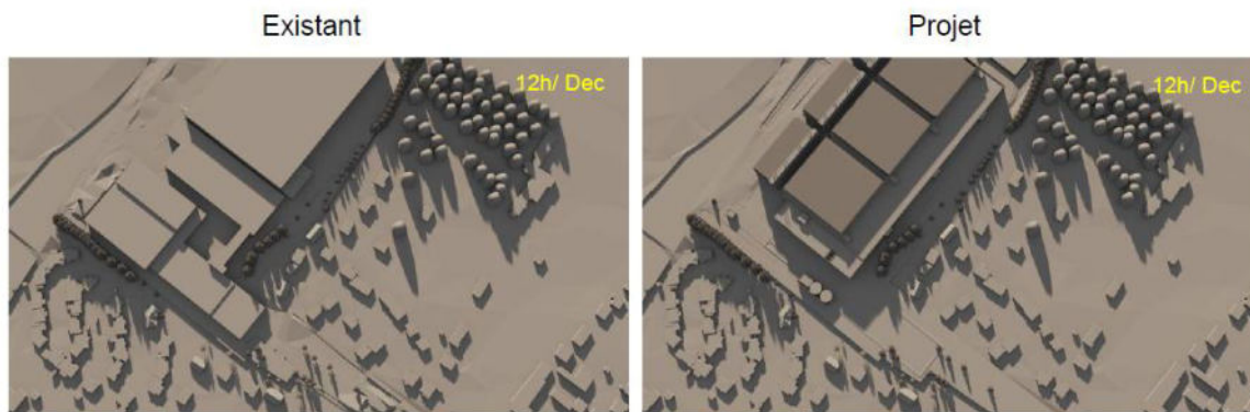
Figure 29 : comparaison d'héliodon entre l'ouvrage existant et le projet (21/Décembre à 12h00)
