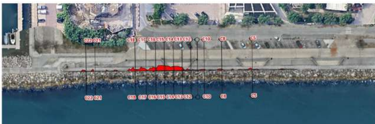
FIGURE 8 : LOCALISATION DES CAVITES SOUS-COURONNEMENT IDENTIFIEES POUR INTERVENTION (2025)
