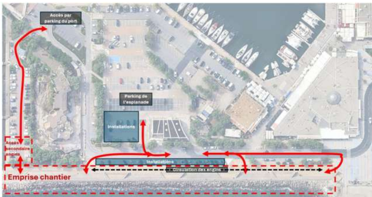
FIGURE 20 : APERÇU DES ACCES A LA ZONE DE CHANTIER DEPUIS LA VOIRIE ET LES ZONES DE STATIONNEMENT
