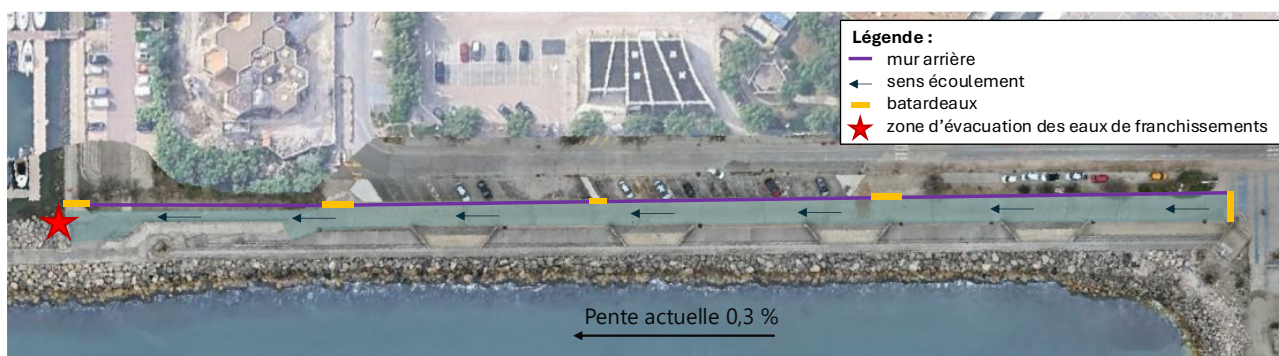
FIGURE 42. PRINCIPE DE LA SOLUTION 2 : GESTION DES EAUX DE FRANCHISSEMENTS
