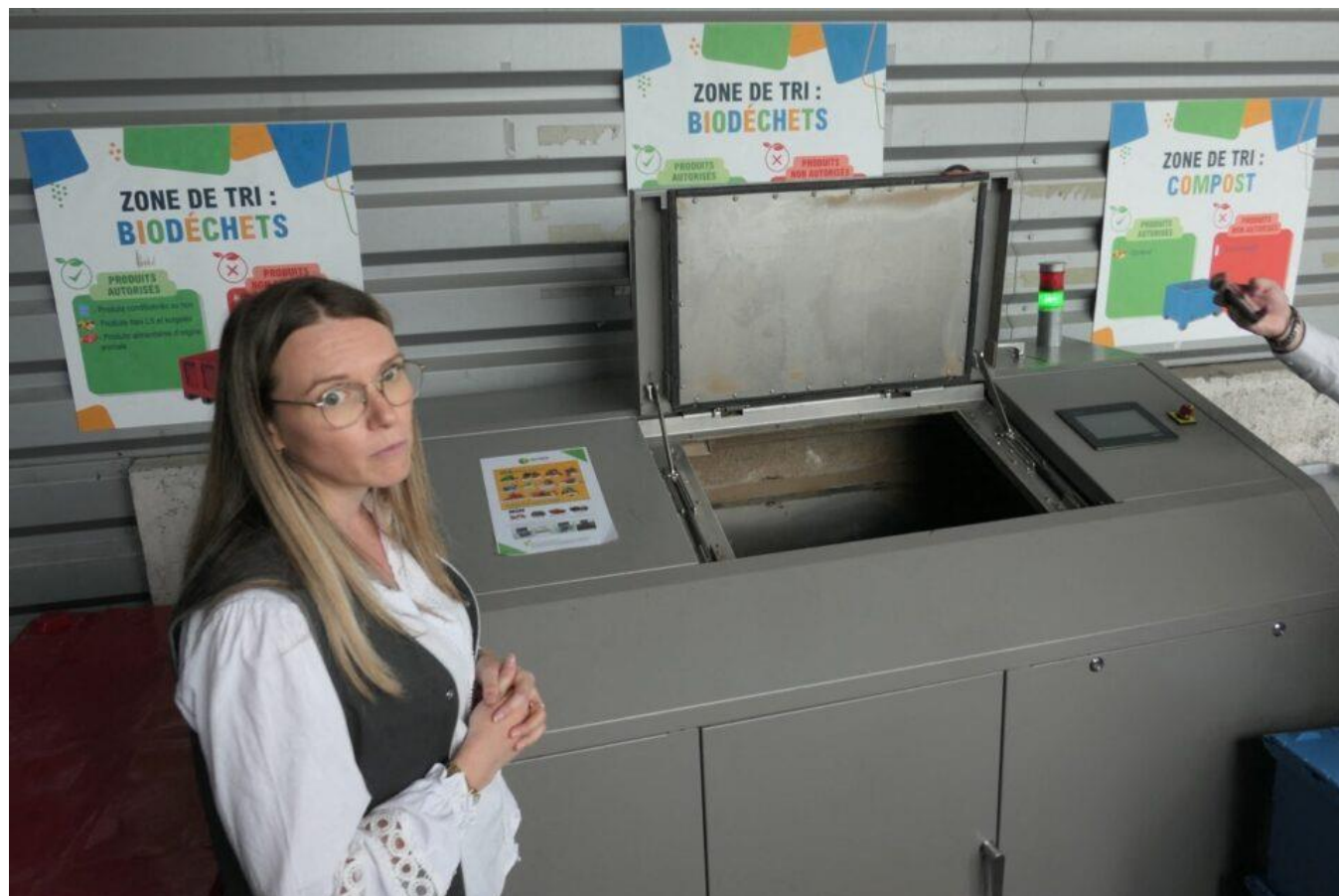
Adeline Chauvet présente le système de transformation accéléré des biodéchets en compost ©Jean-Pierre Riou Après 24 heures, le processus de compostage accéléré est terminé. Des 100 kg de biodéchets initiaux, il ne reste, après transformation, que 10 kg de digestat qui est mis en bac, destiné à la ville de Guérande qui procédera à l'enlèvement sur place avant l'utilisation, comme du compost, dans les espaces verts municipaux. En circuit court À raison de 100 kg traités par jour, c'est une trentaine de tonnes de déchets par an qui sont transformées en moins de 3 tonnes de compost. Cette voie permet de transformer tous les déchets végétaux et animaux, à l'exception près des os, des coquillages et du bois.
