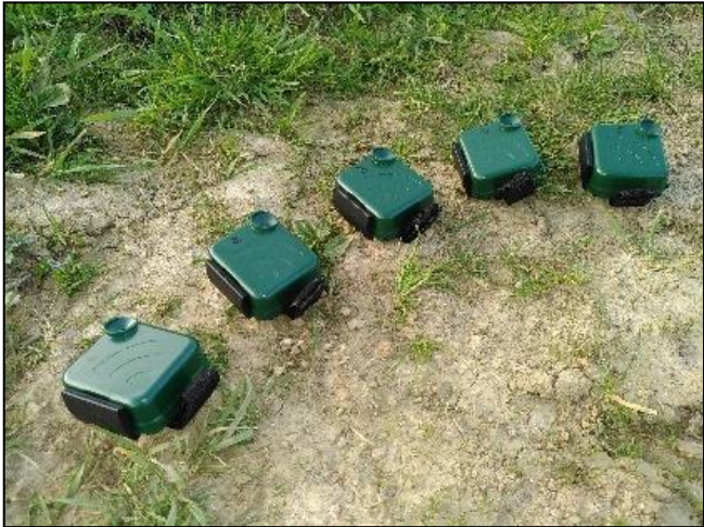
Photographie 2-3 : Appareils de type Audiomoths (TAUW France)
