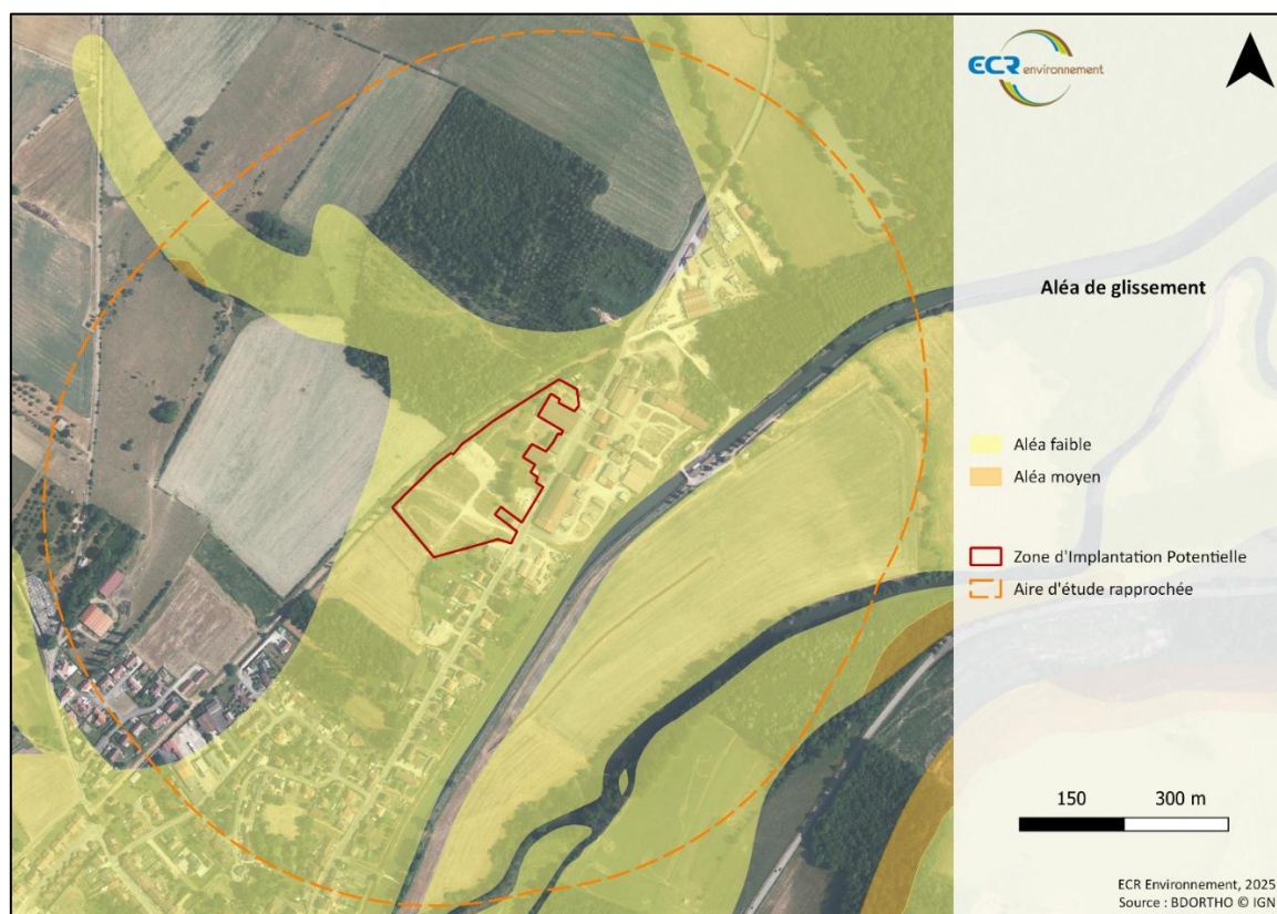
Figure 11 : Aléa de glissement de terrain au niveau du projet
