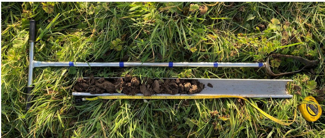
Figure 3 : Exemple d'un prélèvement pédologique disposé dans une gouttière en PVC
