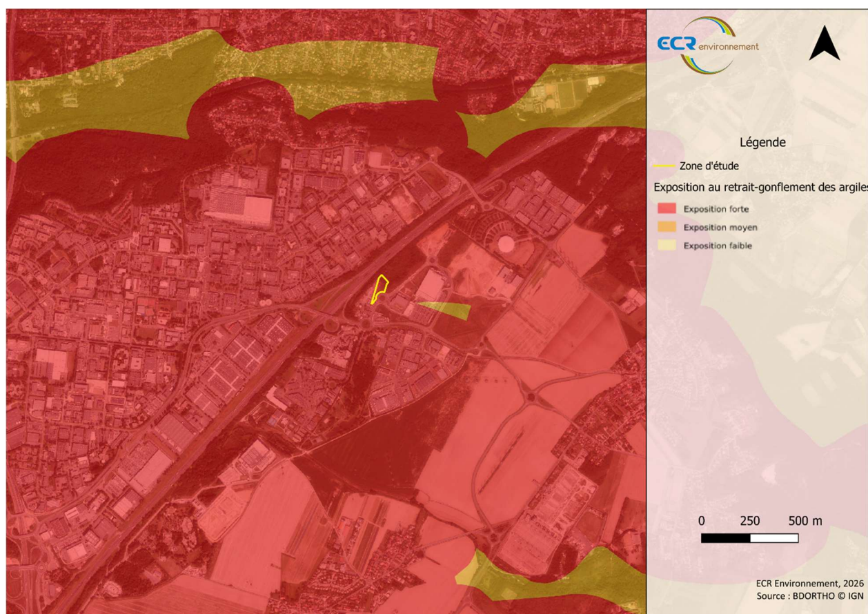
Figure 15 : Exposition au retrait-gonflement des Argiles
