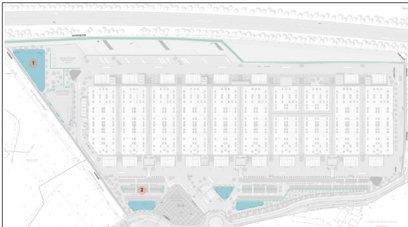
Figure 68 : Localisation des bassins d'infiltration – PAYET
