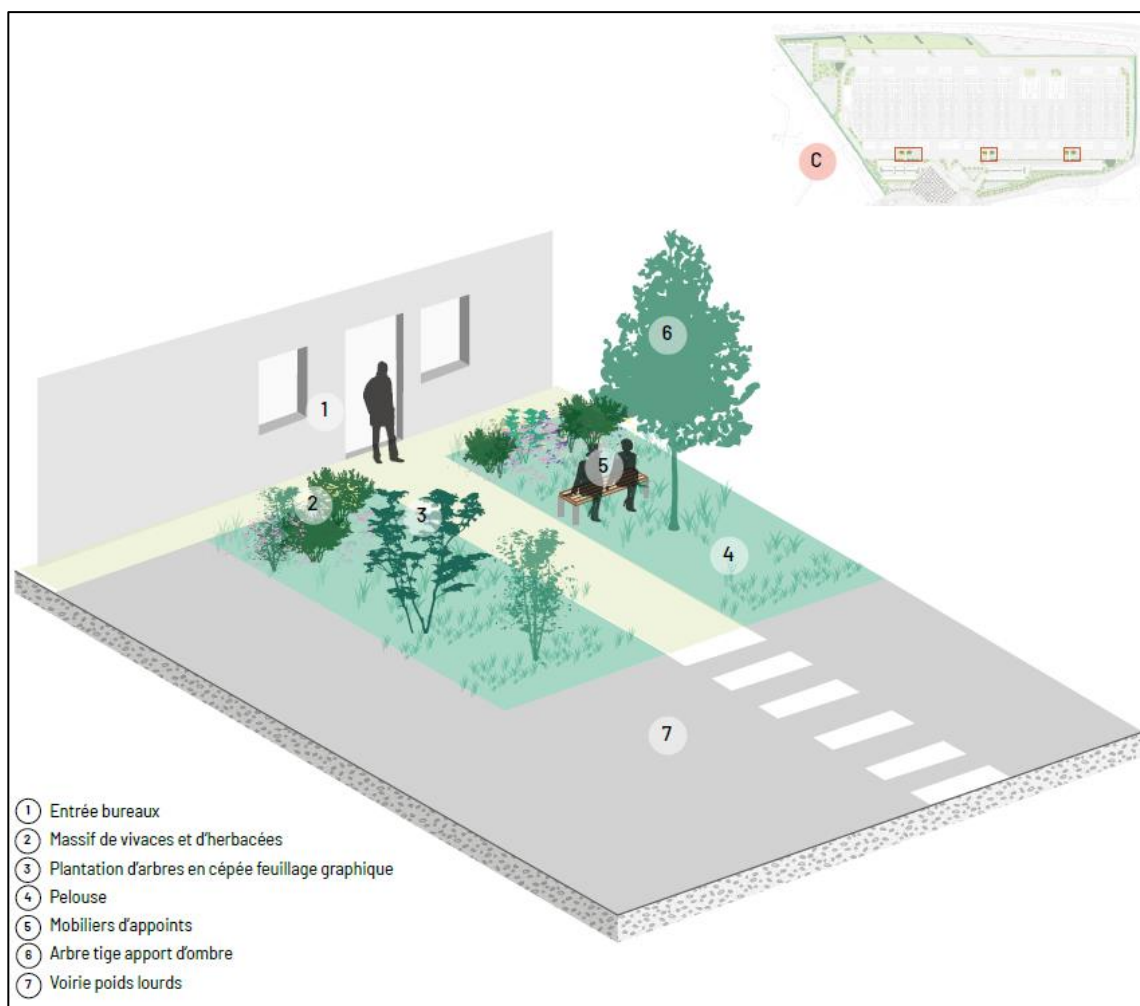
Figure 65 : Description des abords des bureaux - PAYET
