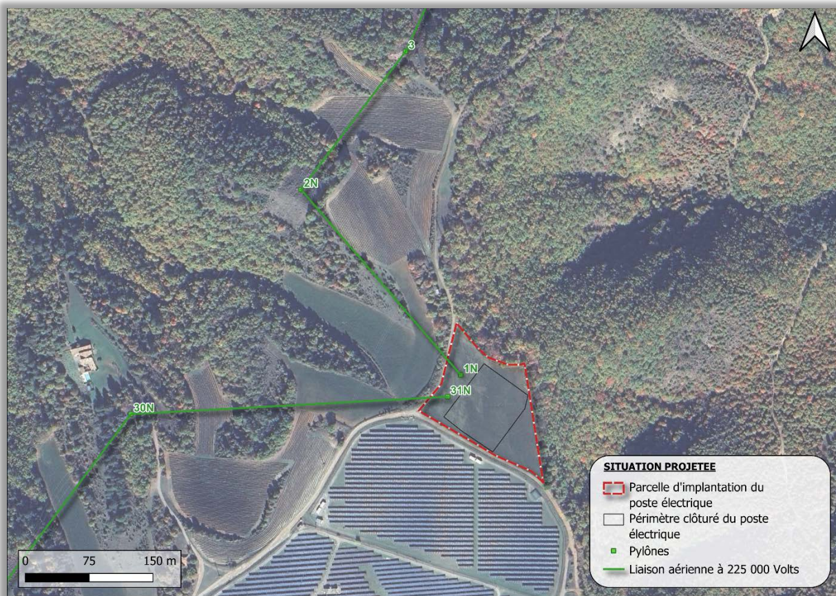
Figure 6: Schéma de principe du projet - Situation projetée
