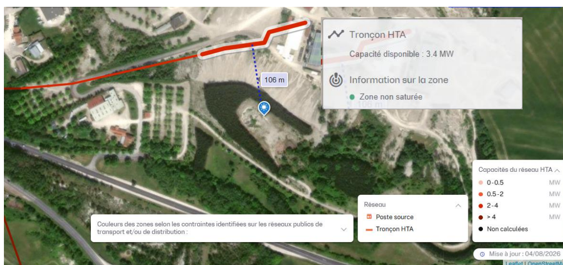
Ligne HTA existante sur le site de la carrière (source : Data Enedis)
