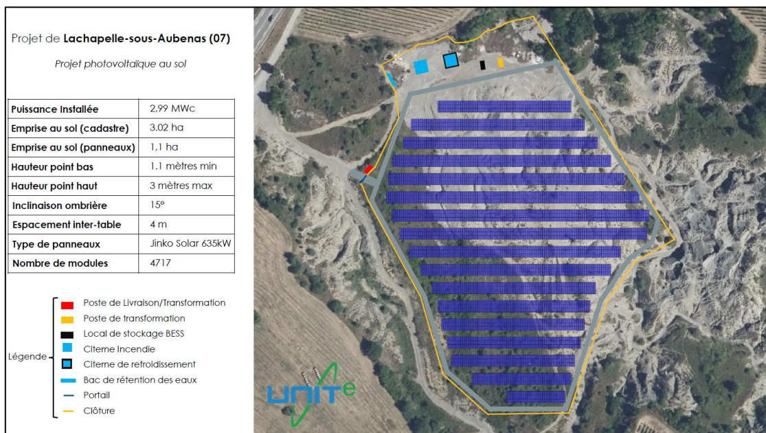
Plan du projet et caractéristiques techniques (source : UNITE, Annexe 5 — Plan du projet, Lachapelle-sous-Aubenas)
