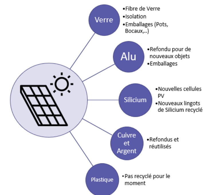
Figure 31 : Composants d'un module PV
