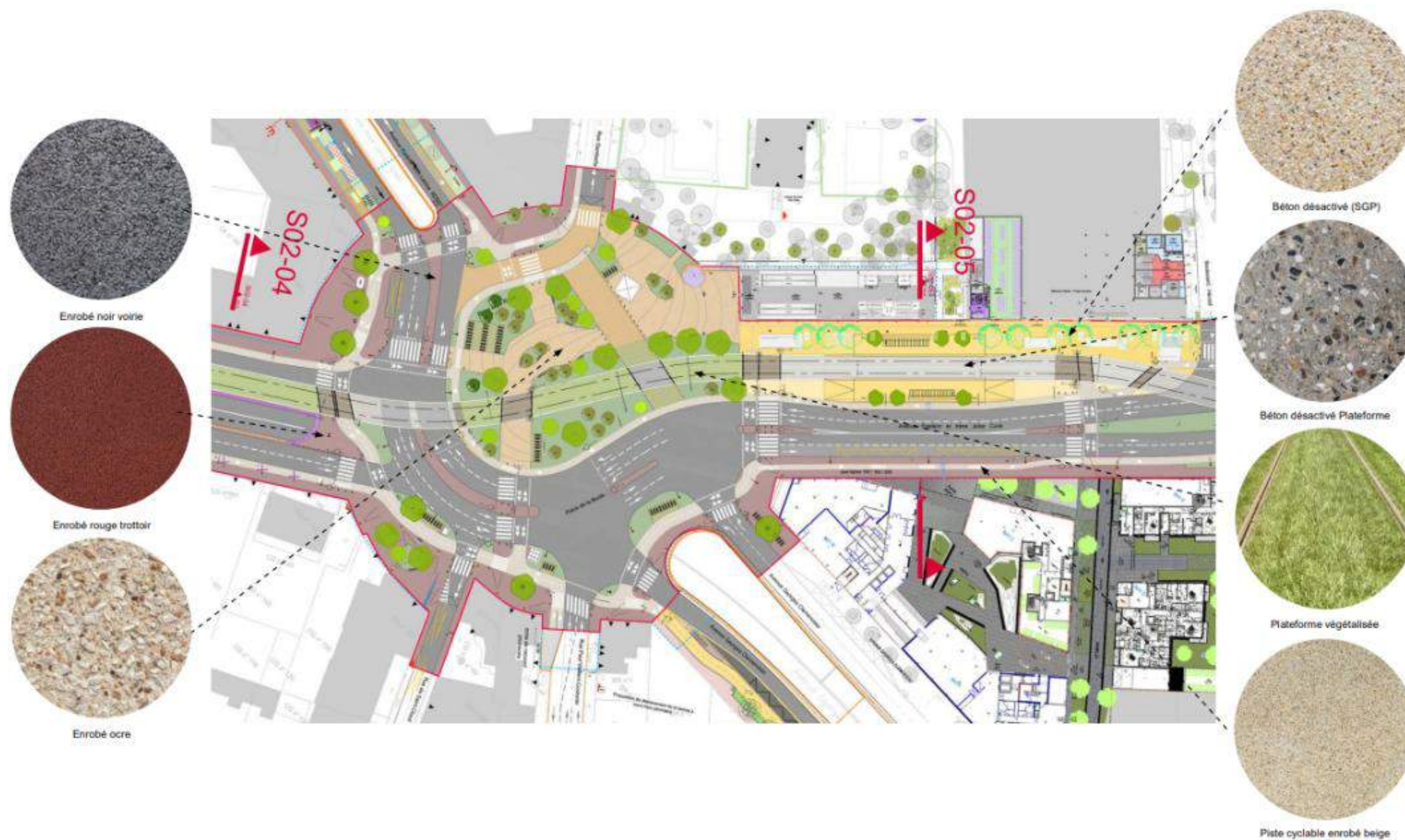
Figure 174 : Revêtements type, séquence 5, place de la Boule
