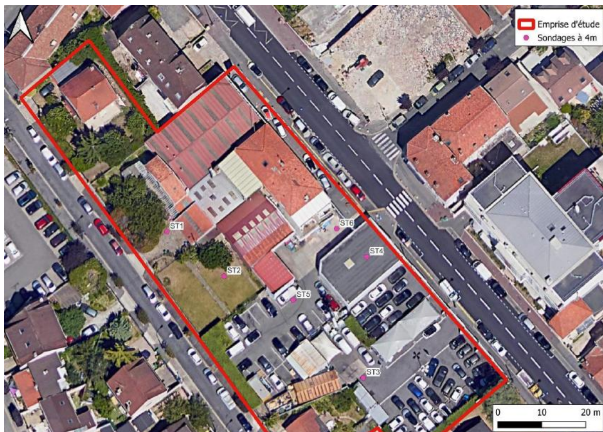
Plan de localisation des sondages et zones à risque (Source : DIAG pollution - SEMOFI)
