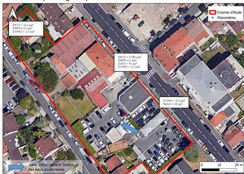
Cartographie des résultats eaux souterraines (Source : DIAG complémentaire)
