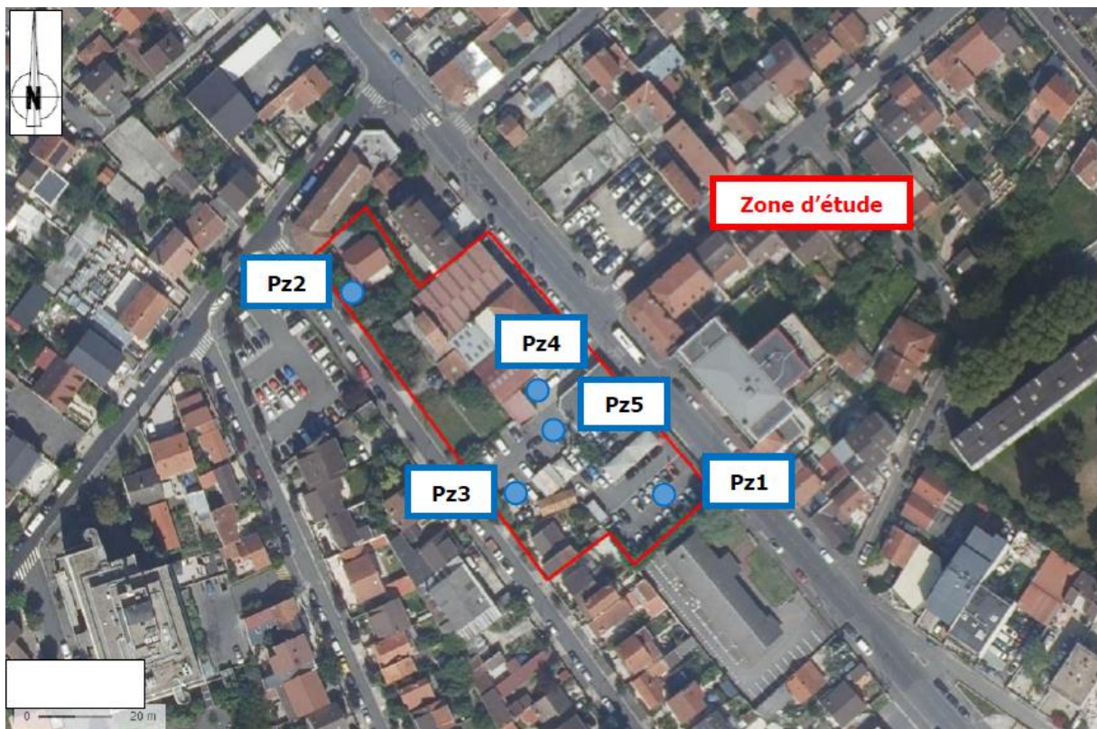
Plan d'implantation des piézomètres (source : extrait étude hydrogéologique SEMOFI)
