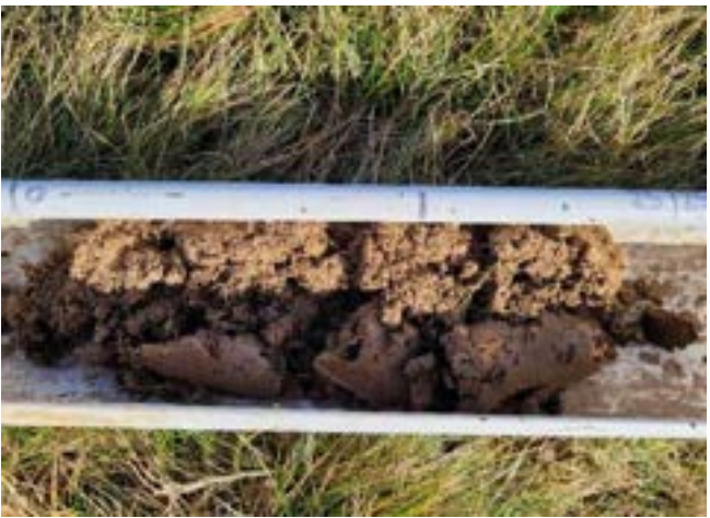
Échantillon prélevé entre 0 et 25 cm de profondeur Profondeur maximale : 25 cm
