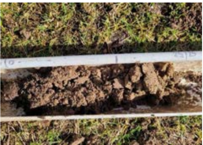
Échantillon prélevé entre 0 et 25 cm de profondeur Profondeur maximale : 25 cm
