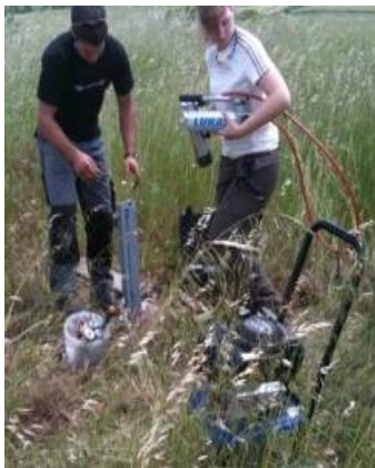
Test de résistance à l'arrachage des pieux
