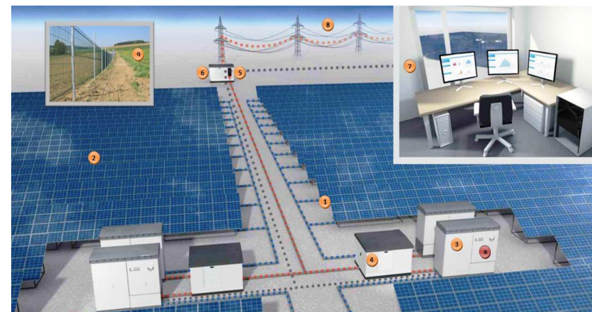
Schéma de principe des composants d'un parc photovoltaïque au sol - Source : d'après SMA, Solutions grands projets, Kompetenz
