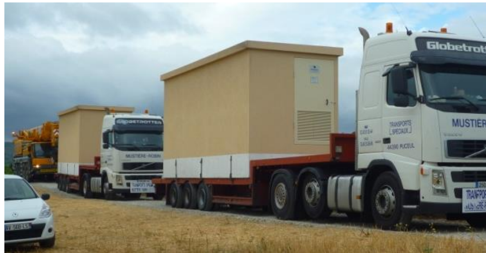
Convoi exceptionnel : Transport des locaux techniques
