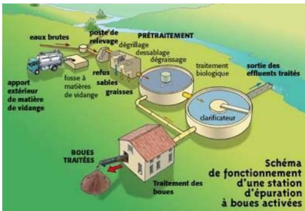
- Schéma STEP boues activées (source - ADEME) -
