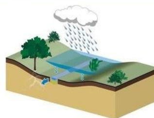
Sol perméable : Noue infiltrante (+cunette de drainage)
