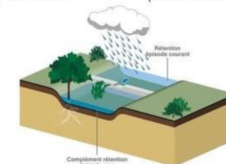
Noue à stockages successifs (fonction de l'intensité des orages)
