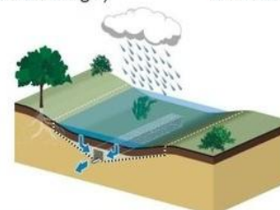
Noue de rétention et de dépollution
