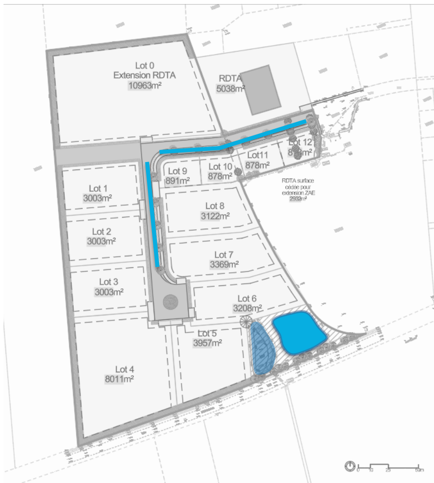
Sol perméable : Noue infiltrante (+cunette de drainage)
