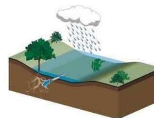
Sol imperméable : Noue à évacuation superficielle
