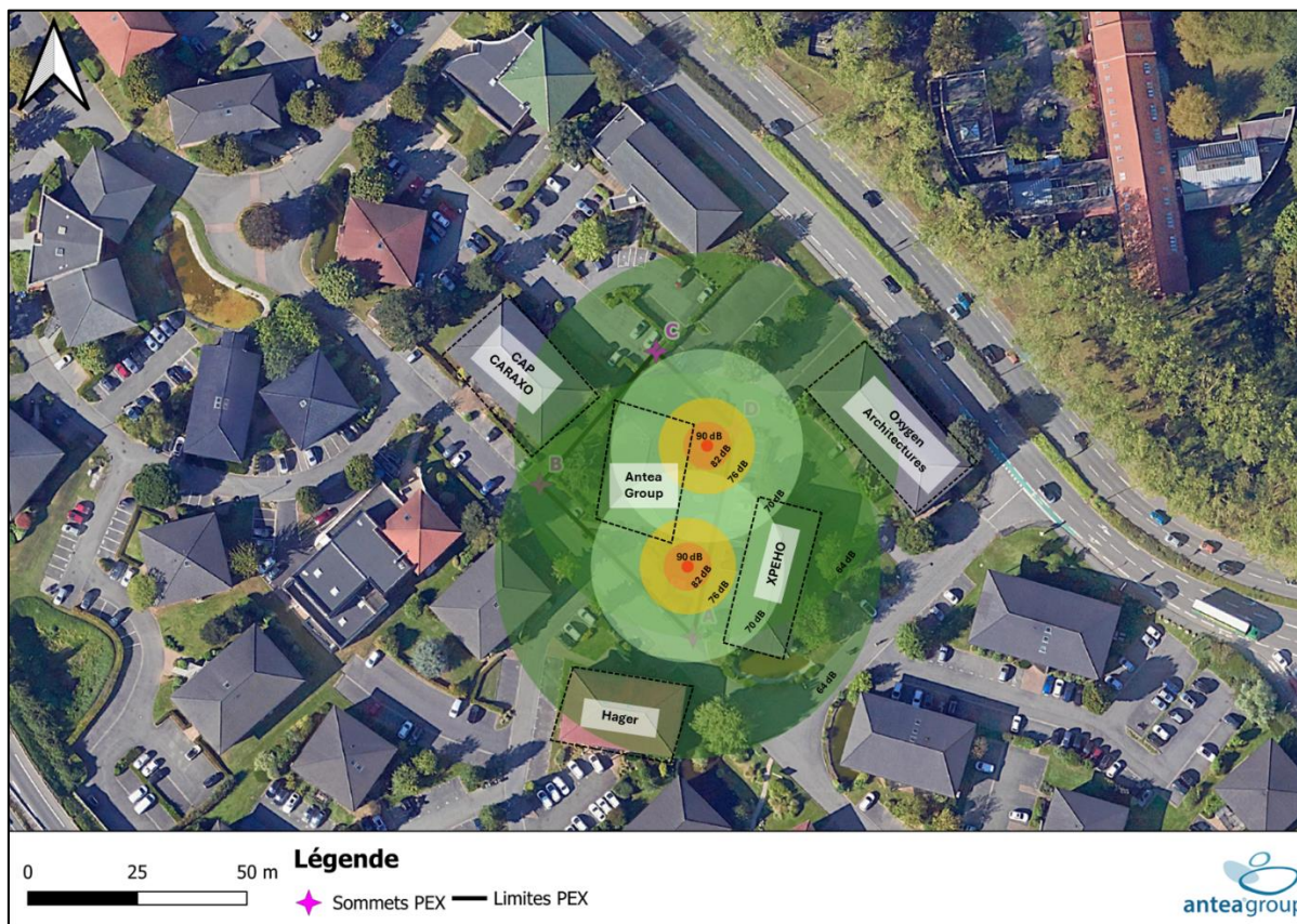
Figure 44 : Niveaux sonores pour les travaux au niveau des sondes géothermiques
