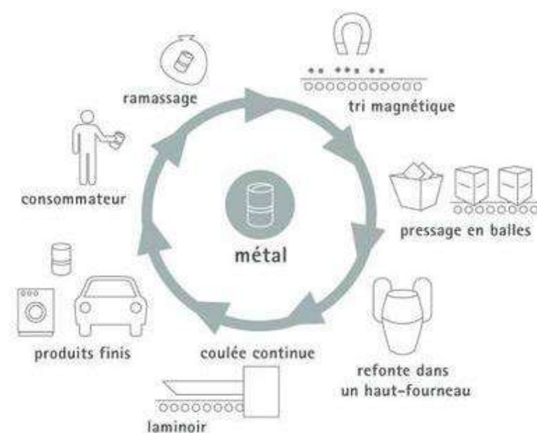
Figure 37 : Cycle de recyclage des structures porteuses (Source : BEJC)
