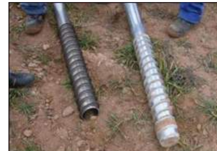
Photo 50 : Exemples de pieux battus à gauche et pieux vissés à droite (Source : Lesage excavation)
