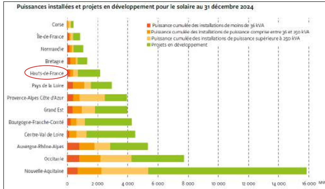
Figure 6 : Puissances solaires installées et en développement par région française au 31 décembre 2024 (Source : SER, RTE, ErDF ET ADEeF, 2025)
