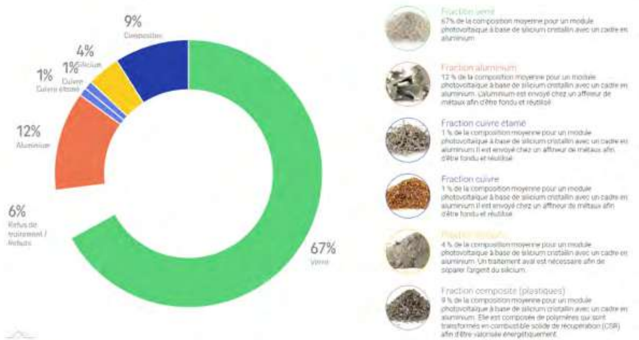
Figure 56 : Répartition des différentes fractions composant un panneau solaire photovoltaïque (Source : SOREN)
