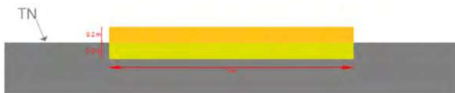
Figure 49 : Plan de coupe simplifié d'une piste lourde
