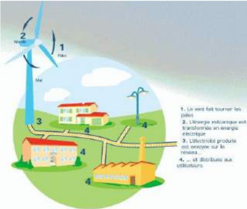
Figure 2 : Fonctionnement de l'éolienne (source : Poitou-magazine.com)
