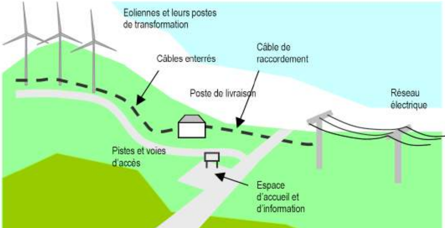
Figure 3 : Les composants d'une centrale éolienne 1
