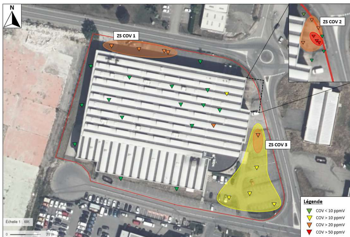
Figure 11 : Détermination spatiale des zones sources en COV dans les gaz du sol
