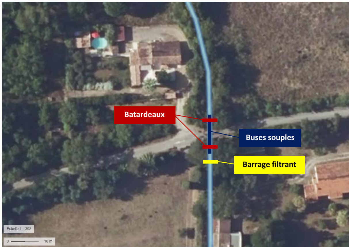
Figure 47 : Schéma de principe de la pose de batardeaux et de buse sur la zone de projet
