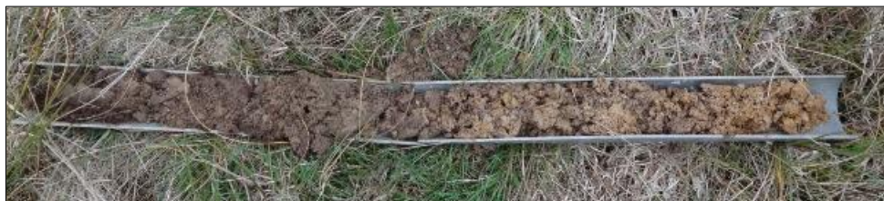
Figure 3 : Exemple d'une carotte de terre réalisée suite à un sondage.
