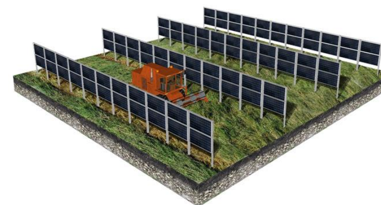
Figure 6 : Schéma de principe de l'agrivoltaïsme impliquant une production de cultures céréalières (Source : ENCIS Environnement)
