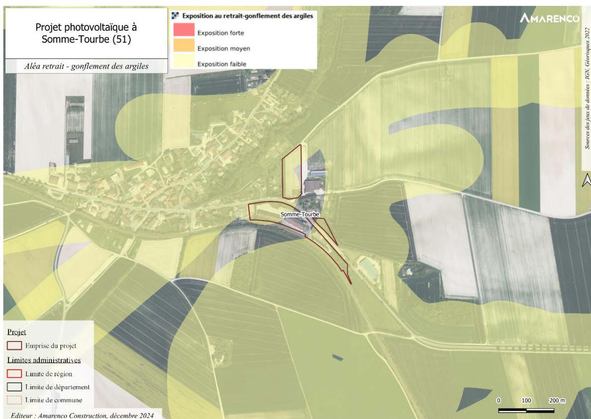
Figure 10 : Exposition au retrait-gonflement des argiles
