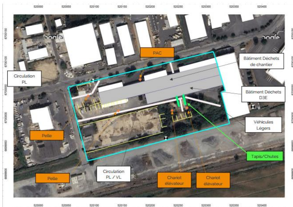
Figure 32 : Ensemble des sources acoustiques modélisées (source : Rapport d'étude acoustique Venatech, 2024)
