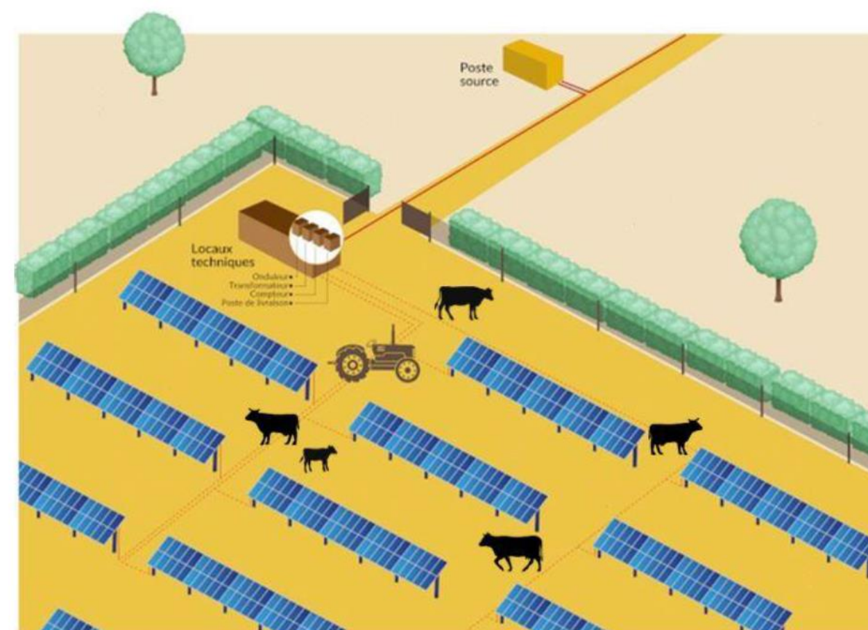
Illustration 1 : Schéma de principe d'une installation-type agrivoltaïque
