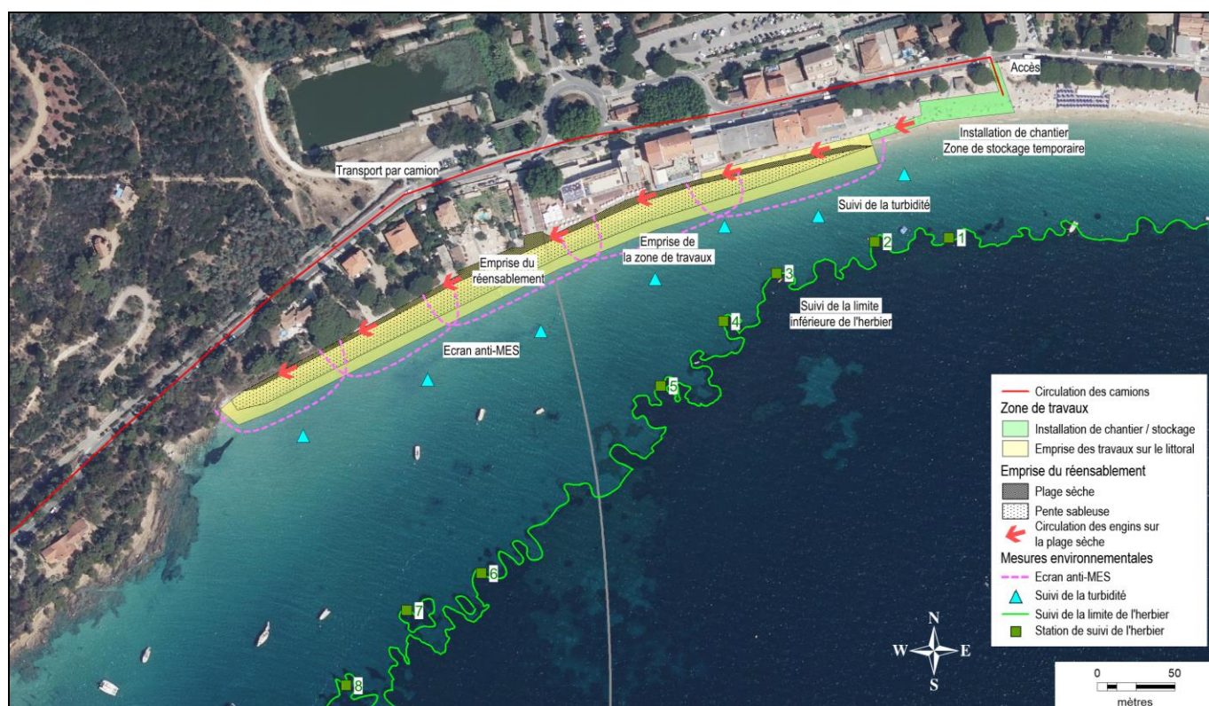
Principe d'organisation des travaux de rechargement de la plage de Cavalière Ouest
