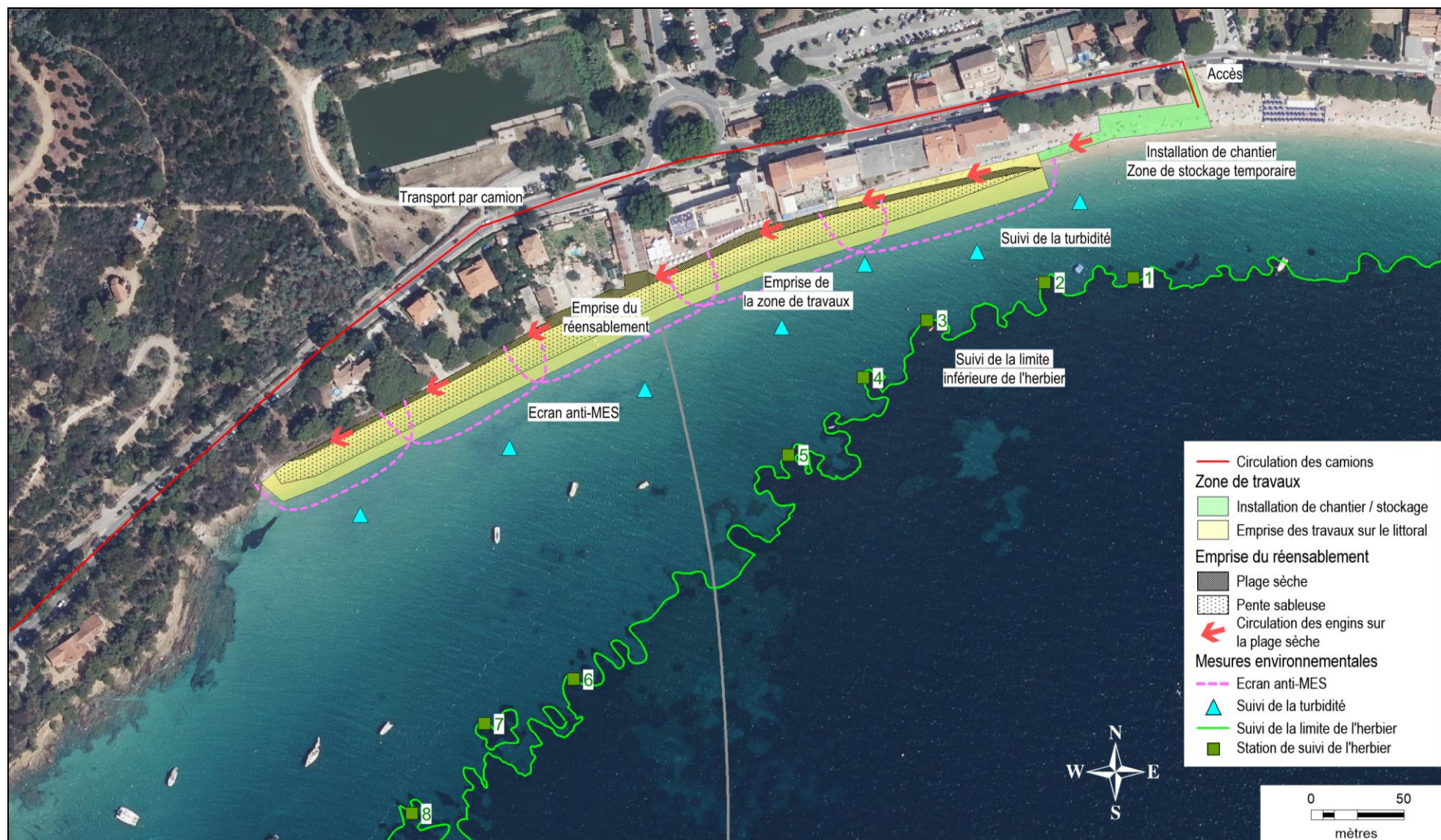
Figure 23 : Principe d'organisation des travaux de rechargement de la plage de Cavalière Ouest
