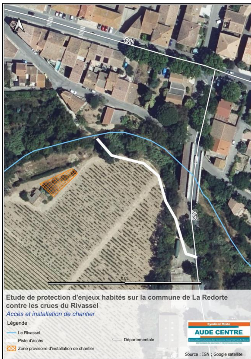
Figure 1 : Accès et installation de chantier
