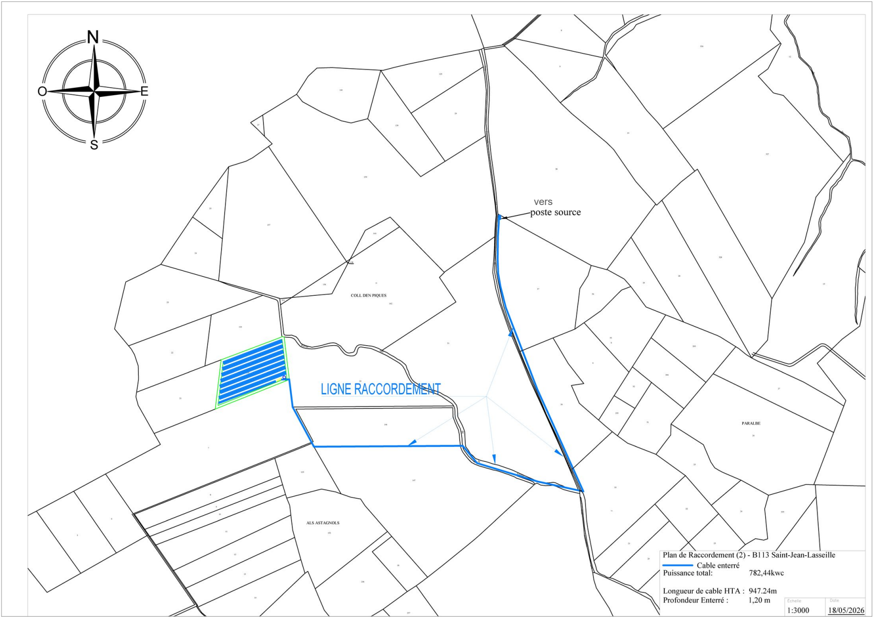
Tracé du raccordement souterrain – environ 940 ml sous voies existantes
