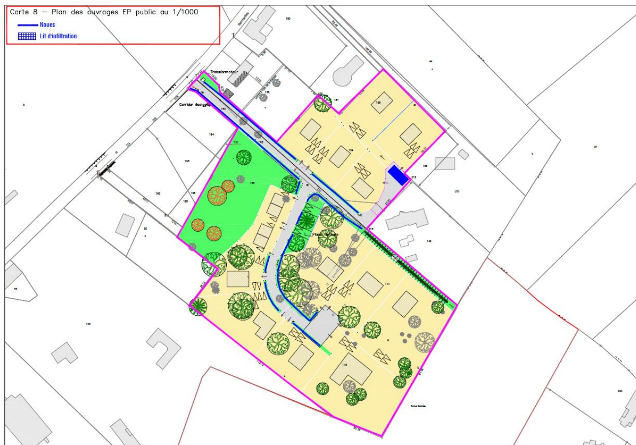
Figure 51 : Schéma de principe de gestion des eaux pluviales projet
