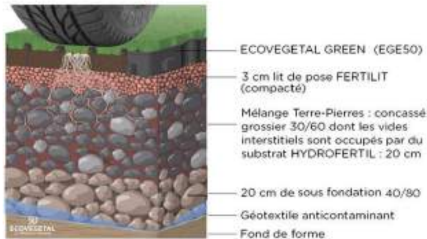
Figure 23 : Coupe de la solution ECOVEGETAL (Source : ECOVEGETAL)
