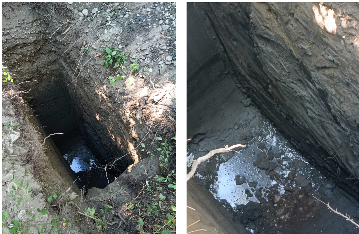
FIGURE 7 : PHOTOS DES ARRIVEES D'EAU DANS LES SONDAGES A LA PELLE – 09/07/2026
