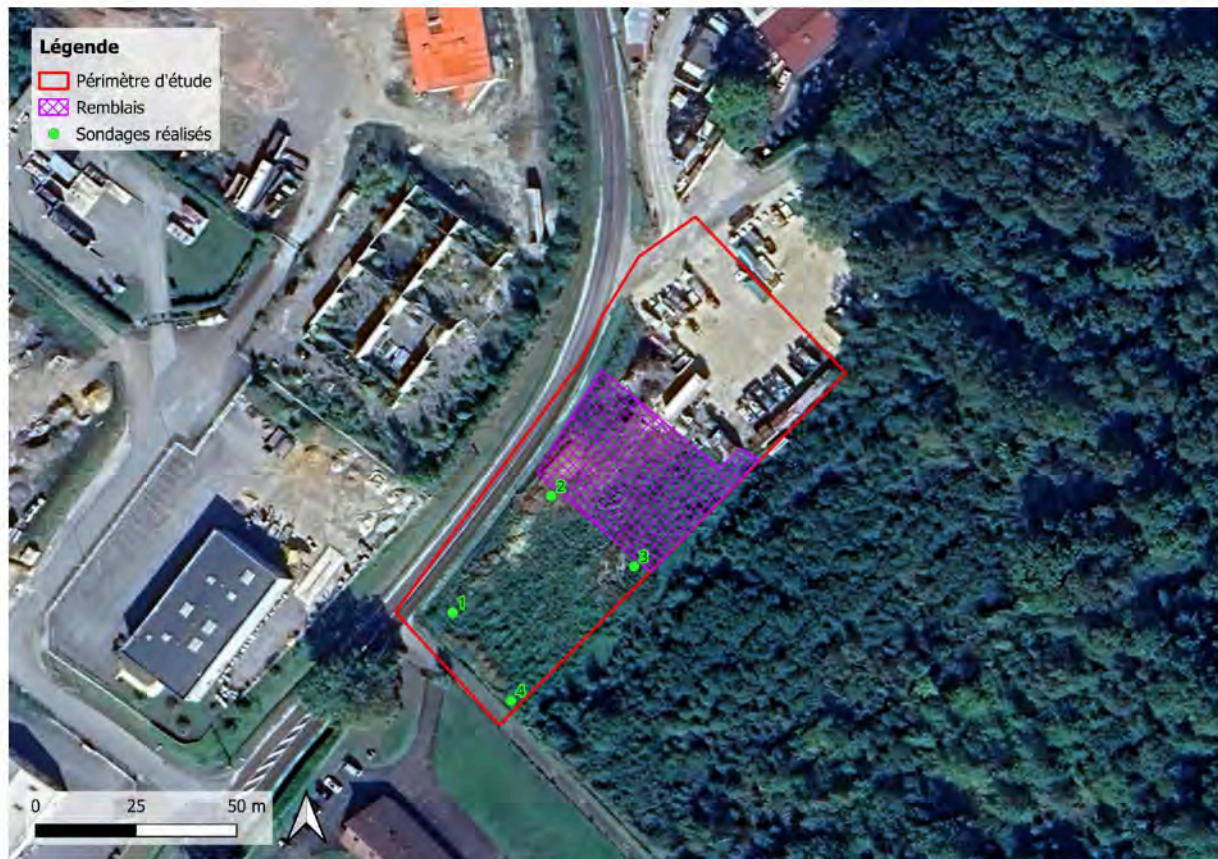
Figure 11 - Campagne de sondages réalisés
