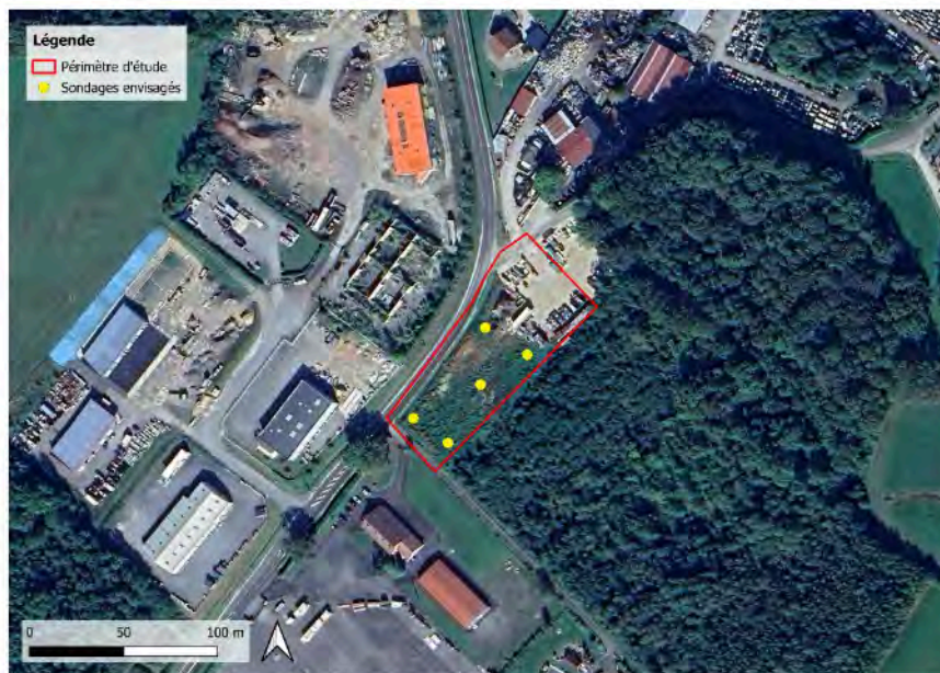
Figure 9 - Campagne de sondages envisagés
