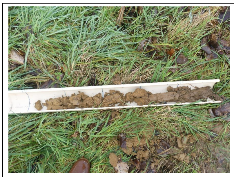
Sondage 01 montrant des limons argileux non hydromorphes
